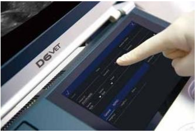
Pantalla táctil de alta sensibilidad de 8 pulgadas que se puede operar con guantes estériles
